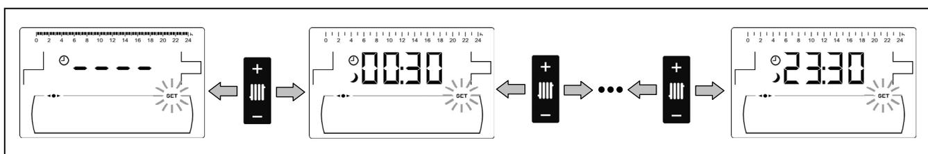
Una vez seleccionada el periodo horario deseado, mediante los símbolos "+" o "-" de ACS **(19)** se modificará el estado de programación de dicho periodo, de "apagado", visualizándose el símbolo ☾, a "encendido", visualizándose el símbolo ☀ y viceversa.
