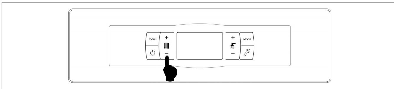
La selección de la temperatura deseada de funcionamiento de la caldera se realiza mediante el selector táctil indicado en la figura. Para seleccionar la temperatura deseada tocar en los símbolos "+" o "-" para incrementar o disminuir el valor de la temperatura, respectivamente. Una vez seleccionada la temperatura, en unos pocos segundos la pantalla regresará a la situación de reposo. El rango de consigna de temperatura de caldera seleccionable es de OFF, 65 - 80 °C.
