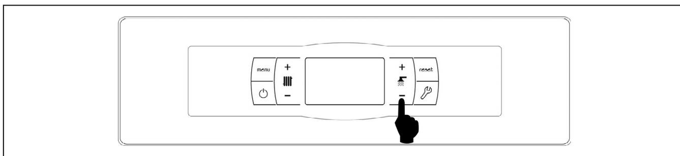
La selección de la temperatura de A.C.S. deseada se realiza mediante el selector táctil indicado en la figura. Para seleccionar la temperatura deseada tocar en los símbolos "+" o "-" para incrementar o disminuir el valor de la temperatura, respectivamente. Una vez seleccionada la temperatura, en unos pocos segundos la pantalla regresará a la situación de reposo. El rango de temperatura de consigna de A.C.S. seleccionable es de OFF, 15 - 65 °C.
