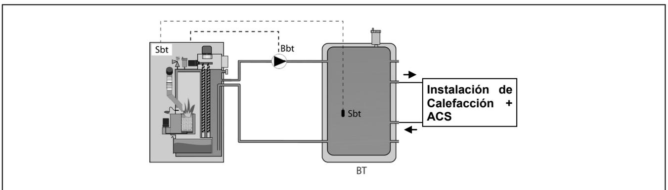
Una vez realizada la instalación hidráulica de todos los componentes de la instalación, para realizar correctamente la conexión eléctrica del depósito de inercia BT con la caldera **BioClass HM** se debe proceder de la siguiente manera:
