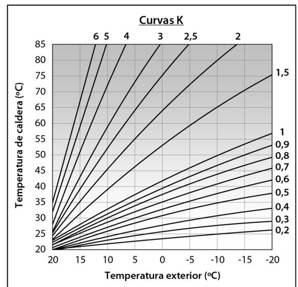
Dependiendo del tipo de circuito, las condiciones de aislamiento del edificio y posición de la sonda variará la curva K óptima para cada circuito de calefacción. De todas maneras, como regla general se recomienda que, para circuitos de calefacción de alta temperatura (p.e. circuito directo de "radiadores") se seleccione una curva K igual o superior a 1, y para circuitos de baja temperatura (p.e. circuito mezclado de "suelo radiante") se seleccione una curva K igual o inferior a 0,8.
