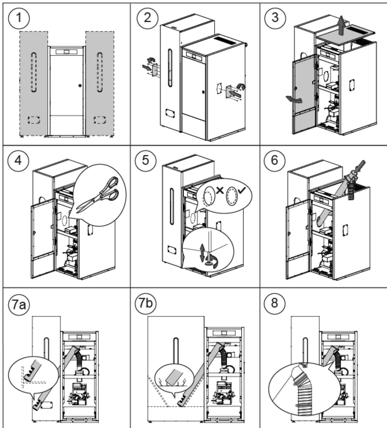
**IMPORTANTE:** Asegurarse de que los agujeros elípticos laterales de la caldera y del depósito de reserva coincidan a la misma altura, para la correcta introducción del alimentador, para ello, realizar los ajustes necesarios, tanto en altura (con las patas reguladoras), como de fondo (situando correctamente el depósito de reserva).
