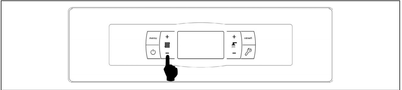
La selección de la temperatura deseada en el depósito de inercia se realiza mediante el selector táctil indicado en la figura. Para seleccionar la temperatura deseada tocar en los símbolos "+" o "-" para incrementar o disminuir el valor de la temperatura, respectivamente. Una vez seleccionada la temperatura, en unos pocos segundos la pantalla regresará a la situación de reposo. El rango de consigna de temperatura seleccionable es de OFF, 30 - 80 °C.
