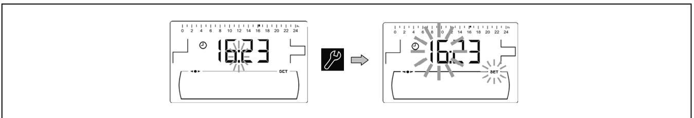
Mediante los símbolos "+" o "-" de ACS (19) se ajusta el valor de las horas y pulsando (🔧) se grabará la hora, pasando a ajustar los dígitos de los minutos.
