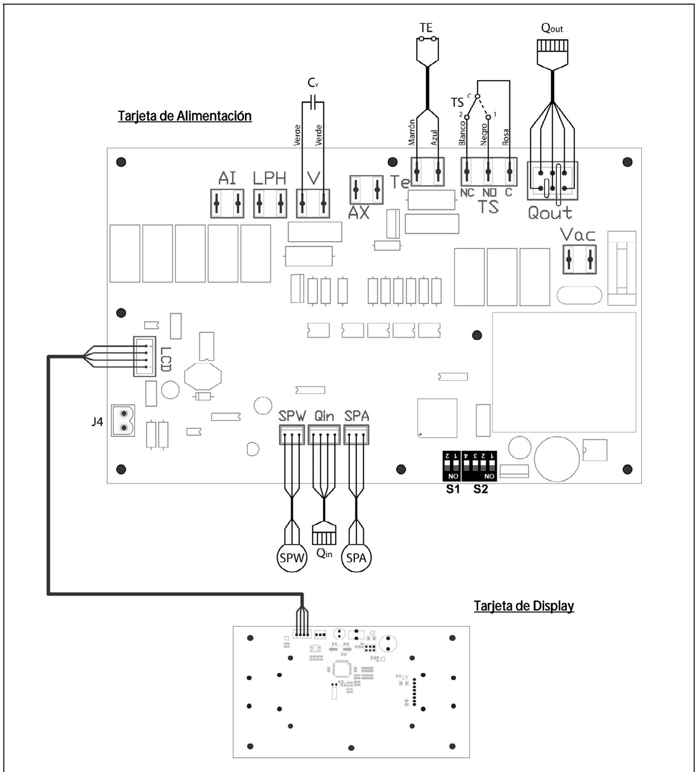
**TS:** Termostato de seguridad.
