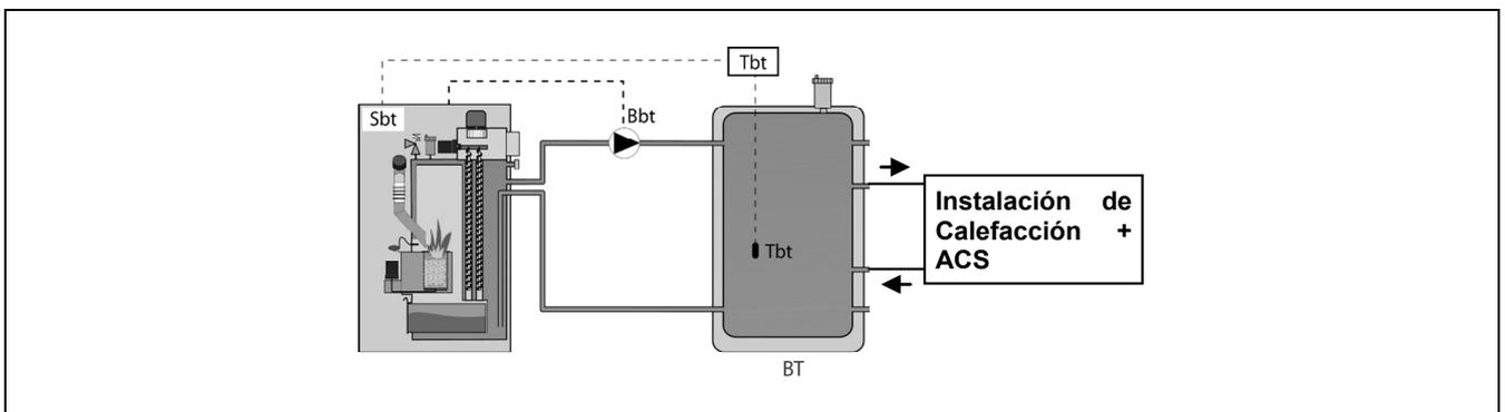
Una vez realizada la instalación hidráulica de todos los componentes de la instalación, para realizar correctamente la conexión eléctrica del depósito de inercia BT con la caldera **BioClass HM** se debe proceder de la siguiente manera:
