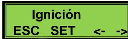
Esta función permite encender/apagar la caldera con horarios programados: gracias al reloj interior y a la batería tampón (3V tipo CR2032), que mantienen día y hora en memoria aún en ausencia de corriente eléctrica.
