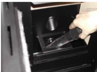
**La periodicidad de esta operación viene determinada por la frecuencia de uso y por la calidad y cantidad de cenizas que presenta el combustible utilizado.**
