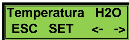
Permite seleccionar la temperatura máxima a la cual puede llegar el agua de la caldera: utilizar las teclas **<-** y **->** para variar el valor desde un mínimo de 10°C a un máximo de 80°C. Presionar **SET** para confirmar
