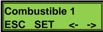
Permite seleccionar hasta 3 tipos de combustible. Desde el menú de ajustes vamos pulsando la tecla **ESC** hasta que aparezca esta pantalla. Presionamos entonces la tecla **SET** y después con las teclas **<-** y **->** seleccionamos el número de combustible correspondiente. Con la tecla **SET** confirmamos la elección, y con la tecla **ESC** salimos sin salvar la modificación.
