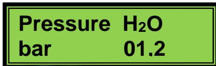
Desde el menú de ajustes vamos pulsando la tecla **ESC** hasta que aparezca esta pantalla. Presionando entonces la tecla **SET** visualizamos la presión de la instalación. Pulsaremos luego la tecla **ESC** para salir.
